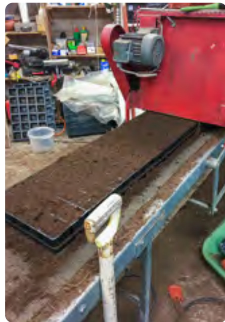
Planteringsmaskinen är till stor hjälp när tusentals blommor ska planteras. Blomjorden finförelas i planteringskrukorna.
